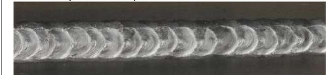
Leve contaminação na superfície do cordão de solda
